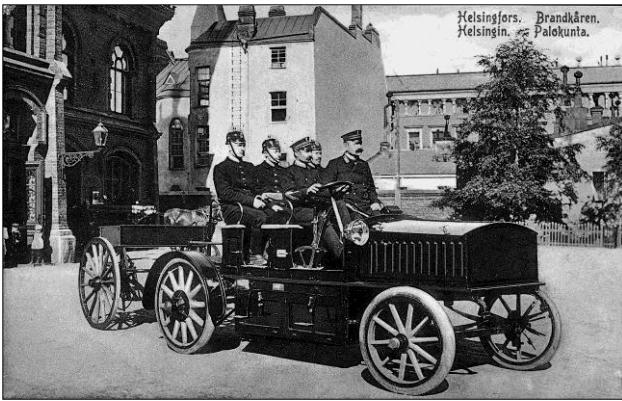
Abb. 1. Erster Feuerwehrwagen in Finnland Dieser Feuerwehrwagen wurde durch die Berufsfeuerwehr von Helsinki im Jahr 1909 angeschafft. Der E-Wagen war in Deutschland hergestellt und dessen maximale Geschwindigkeit betrug 35 km/h. Zur Ausrüstung gehörte eine Gasspritze und zur Mannschaft gehörten neben dem Fahrer vier Männer.
