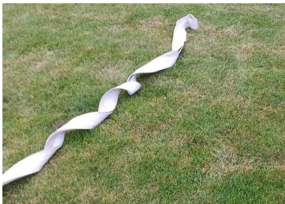
Abb.33a: Schlecht ausgelegter Druckschlauch
