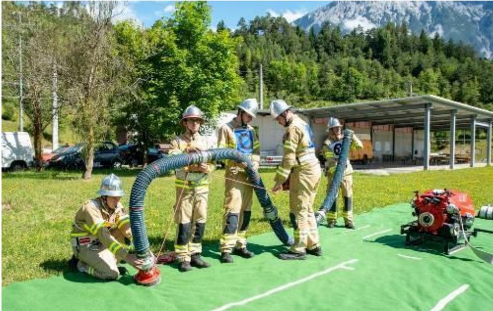
Abb.22: Tragen der Saugschlauchleitung Richtung Wasserentnahmestelle
