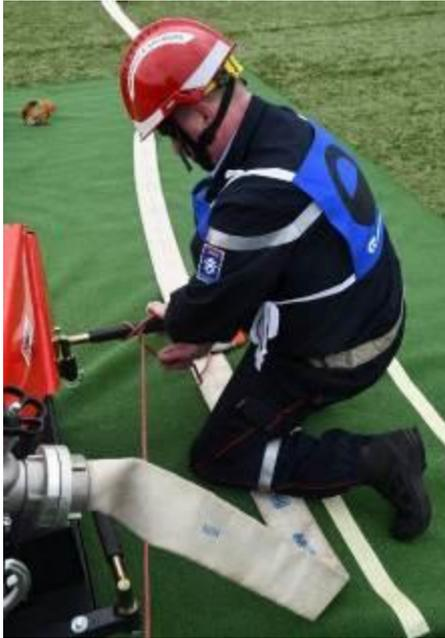
Abb.26: Befestigen Saugschlauchleine an der TS
