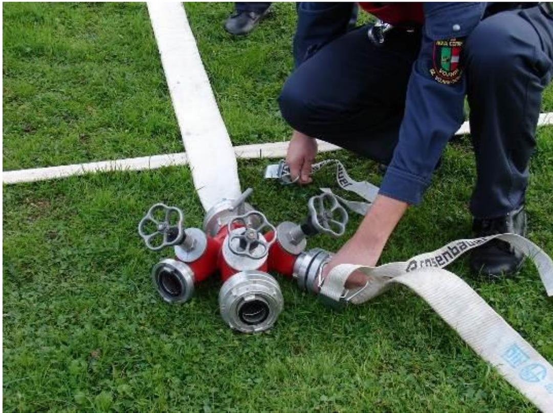
Abb.30: Anschließen der ersten Löschleitung
