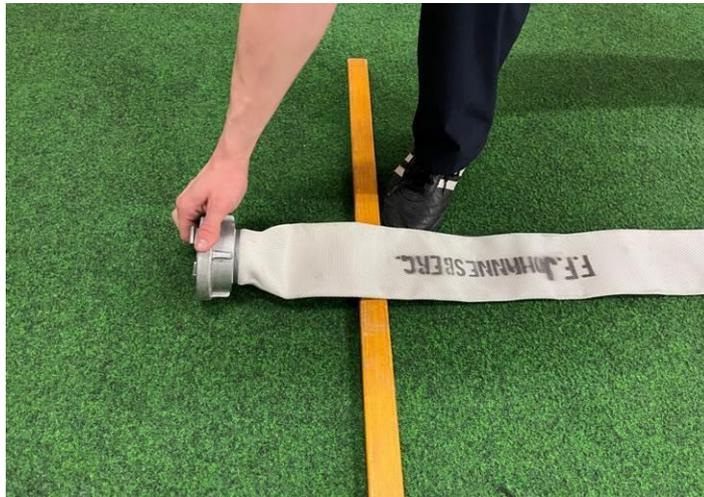
Abb.28a: Richtiges Ablegen der Kupplung des zweiten B-Schlauches
