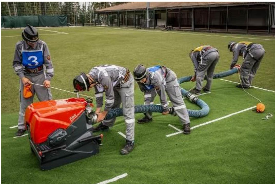
Abb.24: Ankuppeln der Saugschlauchleitung an die Tragkraftspritze
