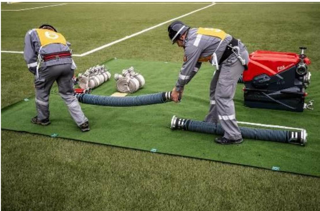
Abb.8a: Auslegen der Saugschläuche durch den Schlauchtrupp
