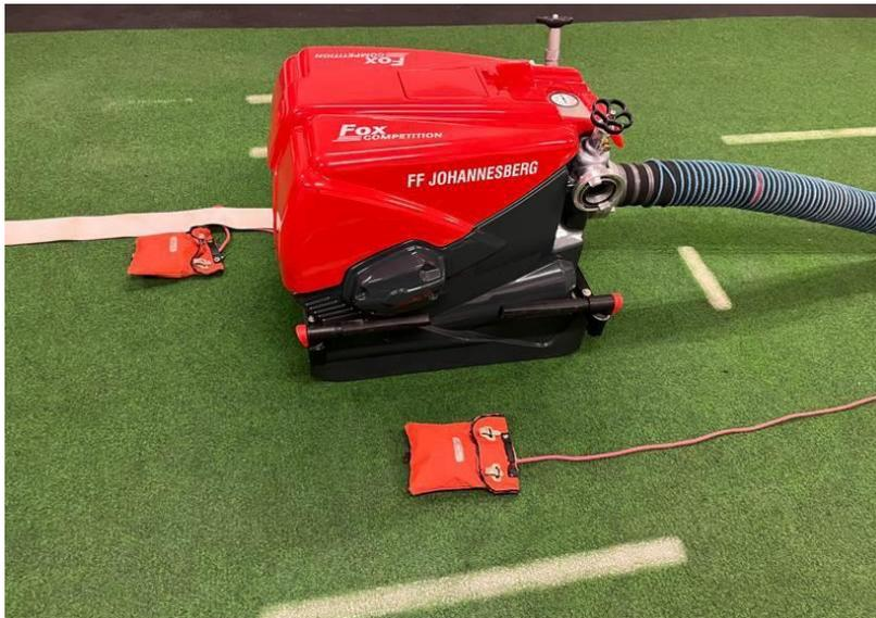
Abb.25: Ablegen des Leinenbeutels mit der Ventilleine
