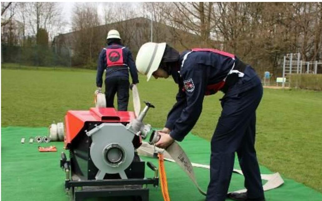
Abb.27: Ankuppeln und Auslegen des ersten B-Schlauches
