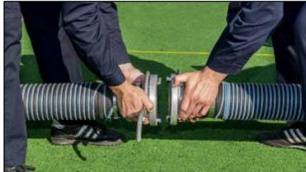
Es ist jedoch auch bestimmungskonform, wenn der Kupplungsschlüssel nur mit beiden „Nasen“ den Metallteil der unteren Fläche der Kupplung berührt (untere Fläche der Kupplung: siehe Abb. 30.)
