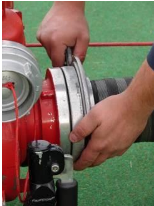
Kuva 24a. Kiinnitetty liitinavain – ei saa hakata, muuten väärä työskentely
