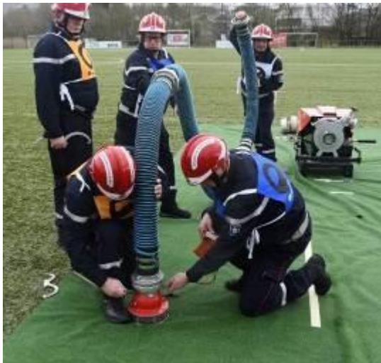
Kuva 21 ja 21a. Liitetty imuletku nostetaan ylös ja imuletkun ja venttiiliköyden asettaminen
