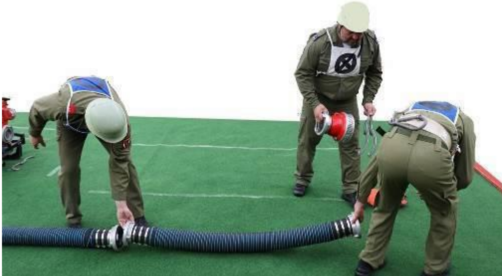
Kuva 9. Oikein asetettu imuletku – imusiivilä ojennettu eteenpäin
