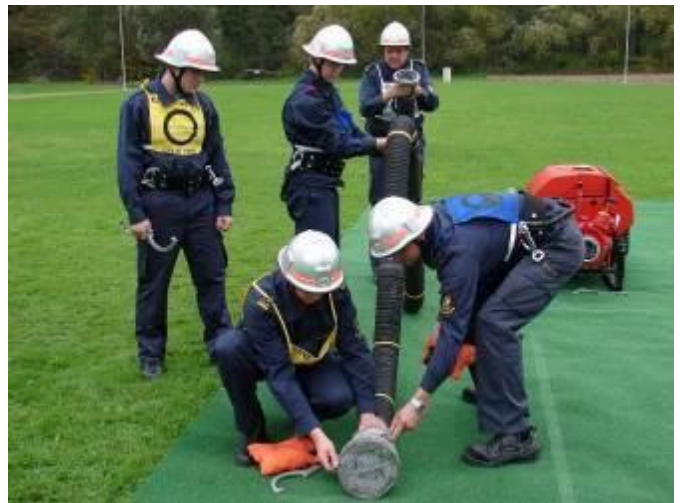
Kuva 21 ja 21a. Liitetty imuletku nostetaan ylös ja imuletkun ja venttiiliköyden asettaminen
