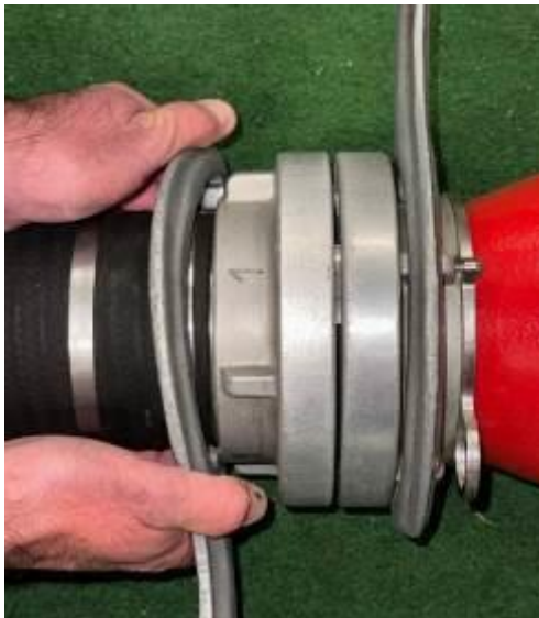
Kuva 18. Liitinavaimen asettaminen ja imuletkun liittäminen
