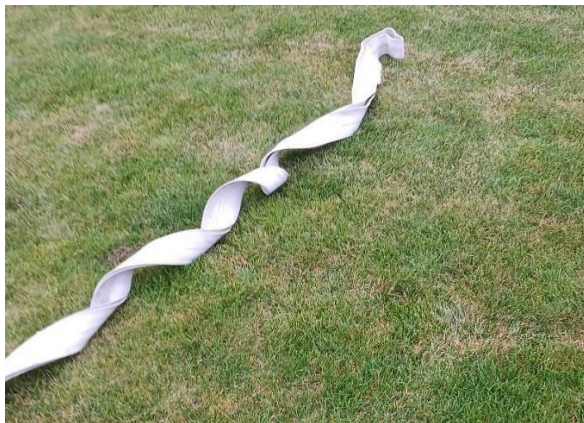
Kuva 33a. Väärin asetettu paineletku
